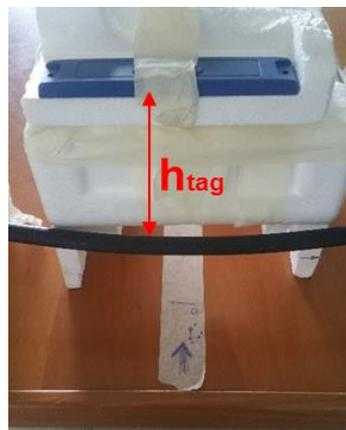
Fig. 1.21 – Supporto di polistirolo con il tag con orientazione parallela a distanza  $h_{tag}=10$  cm dal cavo radiante.
