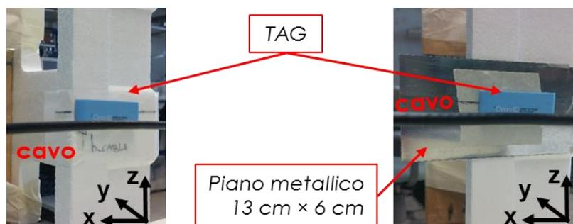
Fig. 1.11 – Esempio di tag posto su supporto di polistirolo con e senza piano metallico.
