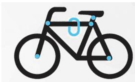
Fig. 2.15 – Punti nel telaio della bicicletta in cui è possibile sostituire i bulloni di serie con quelli del kit “Pinhead” [24].
