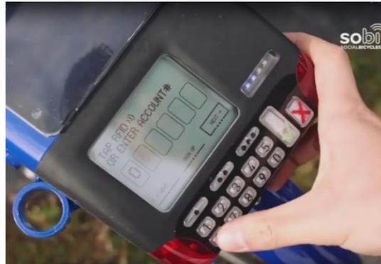
*Fig. 1.8 – Particolare del display del computer di bordo dotato di reader RFID HF che equipaggia le bici “SoBi”. Oltre il meccanismo di sgancio è presente un modulo GPS per la localizzazione [10].*
