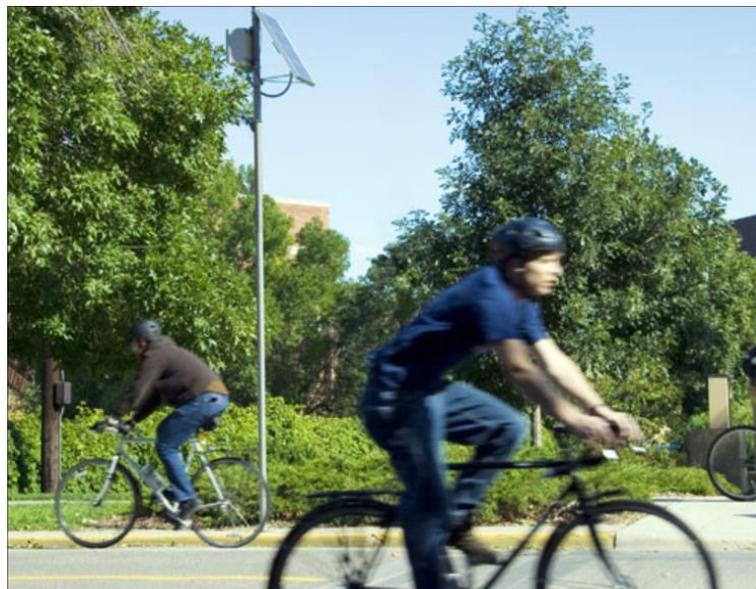
Fig. 1.12 – Antenna del sistema “Dero-ZAP” [11] installata in un campus universitario americano. L'alimentazione è fornita da pannello solare ed il range di lettura massimo è di circa 10 metri.
