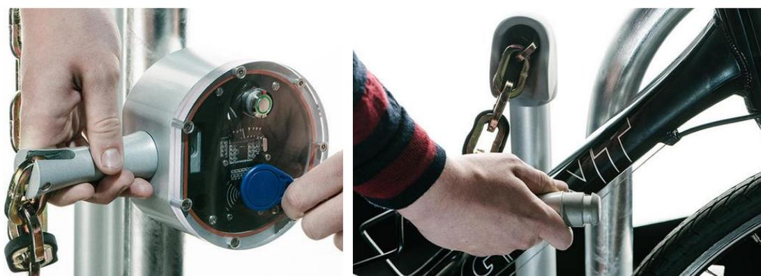
*Fig. 1.6 – Particolare del sistema “Publock” costituito da stalli metallici pubblici dotati di serratura RFID [8].*
