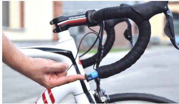
Fig. 2.9 – Dispositivo “Sherlock” collocato all’interno del manubrio di una bicicletta.
