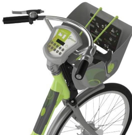
Fig. 1.7 - Particolare della "Smoove box" contenente un lettore RFID HF alimentato mediante dinamo per lettura di card utente implementato nel sistema di bike sharing francese "Smoove" [9].
