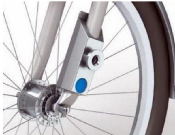
*Fig. 1.3 – Bicicletta equipaggiata con tag RFID HF all'interno del gancio posto nella forcella della ruota anteriore (sistema Nextbike [5]).*
