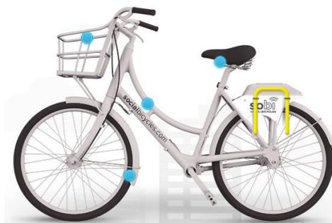
*Fig. 1.9 – Bicicletta del sistema “SoBi” dotata di lucchetto “ad U” sganciabile mediante computer di bordo dotato di reader RFID HF.*
