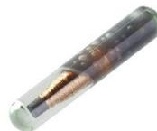
Fig. 2.13 – “Immobitag” da incorporare nel telaio della bicicletta.
